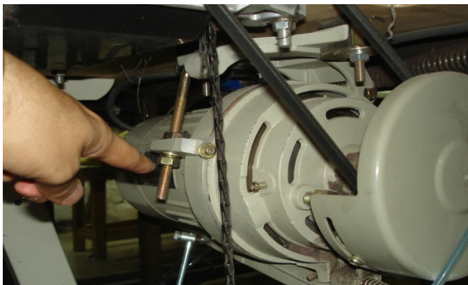
چگونگی تنظیم مکانیکی تسمه اورلاک توسط پیچ رگلاژ. (۲۰۰۸، عکس از آرش آزاده)
