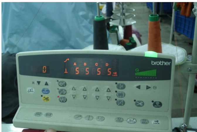
پنل کنترل چرخ z56 دکمه‌های کاهش و افزایش سرعت و نمایشگر مربوط به آن در قسمت بالایی پنل در سمت راست دیده می‌شود. (۲۰۰۸، عکس از آرش آزاده)
