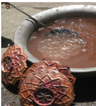
تصویر ۸: غوطه ور کردن ظرف لحیم کاری شده در آب
