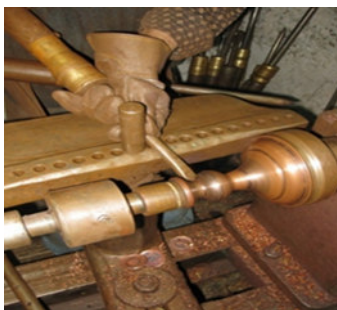
تصویر ۳: فرم دهی ورق مس با دستگاه خمکاری
