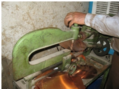
تصویر ۱: برش ورق مس به شکل دایره با دستگاه گرده بر
